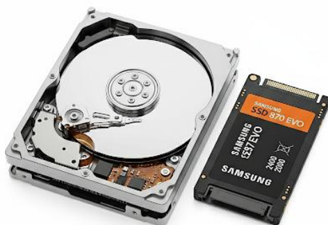
Figure 3 – Deux technologies de stockage : un disque dur mécanique (HDD) ouvert et un disque dur SSD
